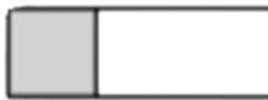
ภาพที่ 2.10 Data Store แหล่งจัดเก็บข้อมูล
